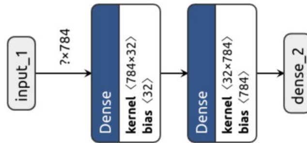
Figure 3.2 Modèle d'un simple auto-encodeur à 2 couches : encoded et decoded
